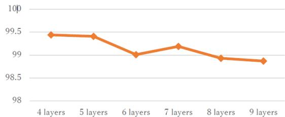
図 2 ViT の Encoder の個数による精度の違い
